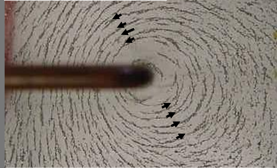
Magnetfeld mit Eisenfeilspänen
